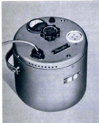
Regeltransformator »Regelfix« 1500 VA prim. 90 bis 240 V, sek. 0 bis 150 V Abmessungen: 220∅ x 237 mm
